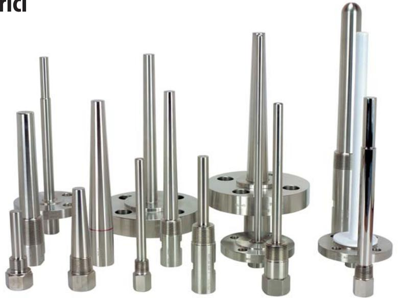
I pozzetti termometrici sono utilizzati per proteggere il bulbo dalla corrosione, dalla pressione, dalla velocità del fluido di processo ed inoltre permettono l'intercambiabilità del termometro per la ricalibrazione e/o la sua sostituzione senza interrompere il processo.
